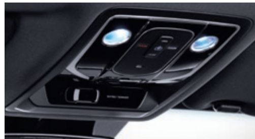
Dachkonsole mit Raumleuchte und Sicherheitsgurt-Erinnerung
