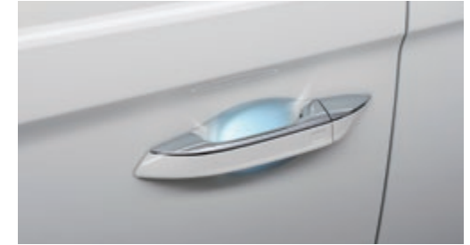
Türgriffe beleuchtet, bei Smart-Key: Entriegelung bei Berührung
