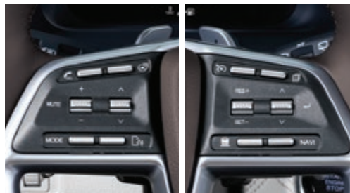
Lenkradfernbedienung für Audiosystem/ Geschwindigkeitsregelanlage
